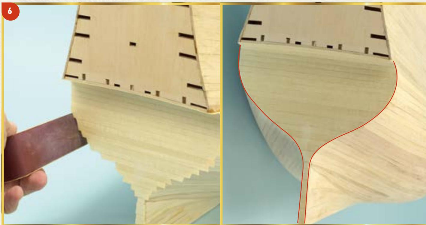
**6** Когда вся нижняя кормовая часть корпуса будет обшита, с помощью наждачной бумаги удалите части планок, выступающие за края корпуса. При этом помните о том, что движения следует совершать только по направлению к корпусу: таким образом вы избежите отслоения или даже полного отклеивания планок.
