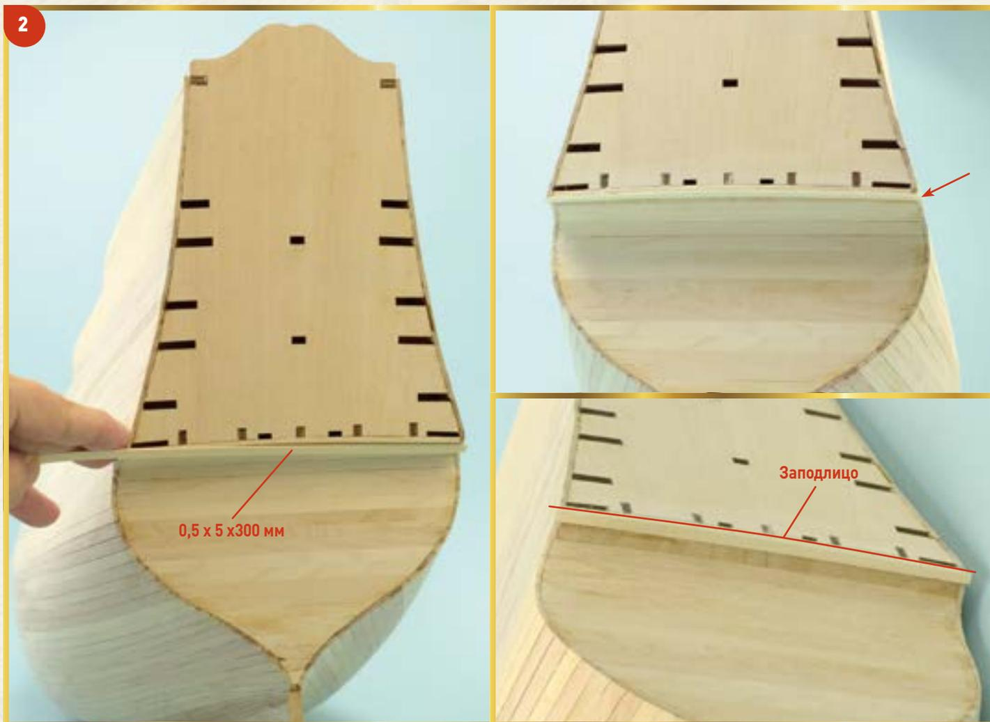
**2** Начните работу с кормовой части судна. От планки 0,5 x 5 x 300 мм отрежьте фрагмент нужной длины, оставив небольшие припуски по краям. Приклейте этот фрагмент так, чтобы его край слегка выступал над транцем (см. фотографии). Когда клей полностью высохнет, наждачной бумагой обработайте планку, сделав ее край вровень с транцем.
